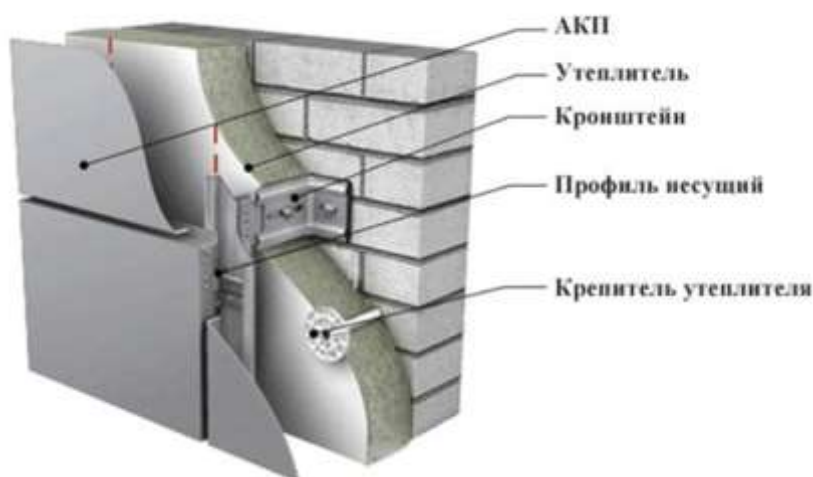
Рис. Пр2.2. Устройство вентилируемой прослойки в стене
