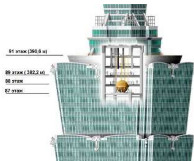
Рис. 3.29. Расположение стального шара в небоскрёбе Тайбэй 101
