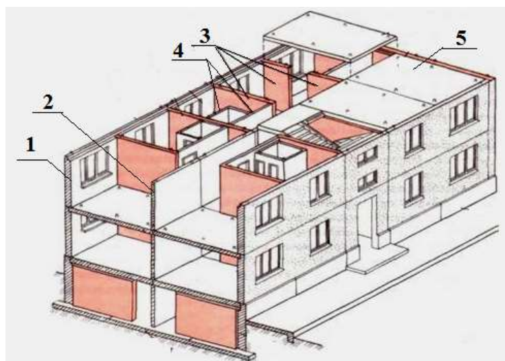
Рис.1.3. Конструктивная система с несущими стенами: 1 – продольная несущая наружная стена; 2 – продольная несущая внутренняя стена; 3 – поперечная несущая внутренняя стена; 4 – перегородка; 5 – перекрытие
