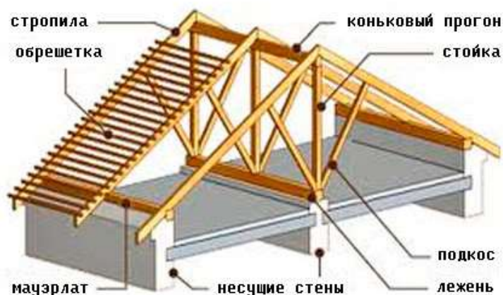
Рис. Пр1.72. Покрытие по наслонным стропилам
