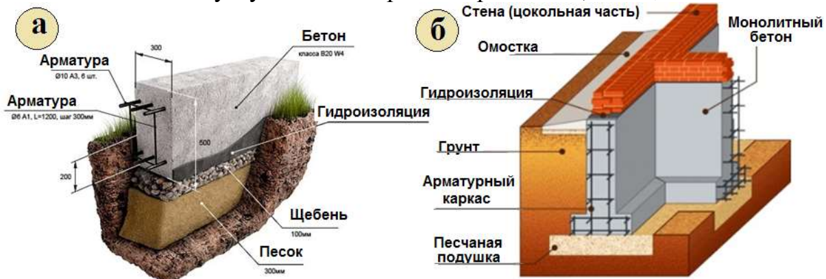
Рис. Пр1.5. Типы ленточных фундаментов по форме поперечного сечения: а – прямоугольный; б – ступенчатый
