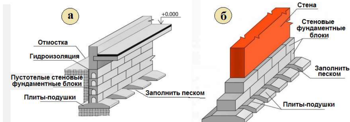
Рис. Пр1.7. Устройство прерывистого сборного ленточного фундамента: а – с использованием пустотелых стеновых фундаментных блоков; б – с цельными стеновыми фундаментными блоками
