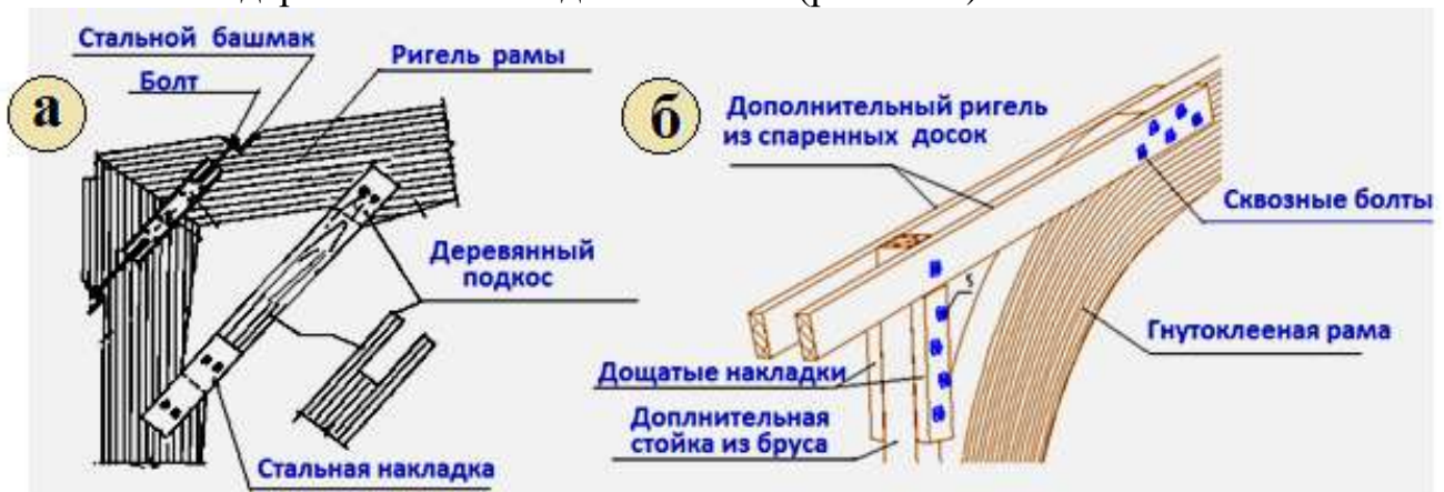
Рис. 2.29. Карнизные узлы деревянных рам: а – с монтажным сопряжением ригеля и стойки; б – для рамы из гнутой древесины
