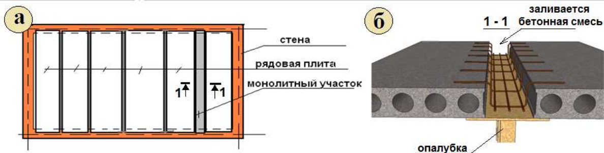
Рис. Пр1.60. Устройство плитного перекрытия в здании с несущими стенами: а – план перекрытия; б – устройство моноконтинентного участка
