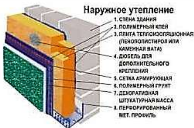
Рис.Пр2.1. Конструкция многослойной стены
