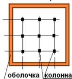
Рис. 1.12. Схема расстановки в плане вертикальных несущих элементов в каркасно-оболочковой системе
