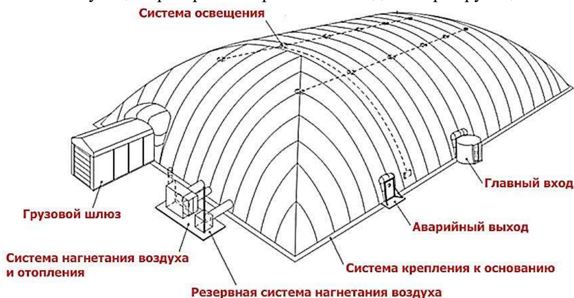
Рис. 2.51. Устройство пневматического воздухоопорного покрытия
