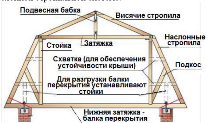
Рис. Пр1.83. Стропильная система мансарды
