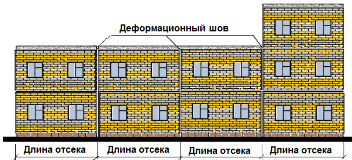
Рис. 1.25. Деление здания вертикальными деформационными швами на отсеки
