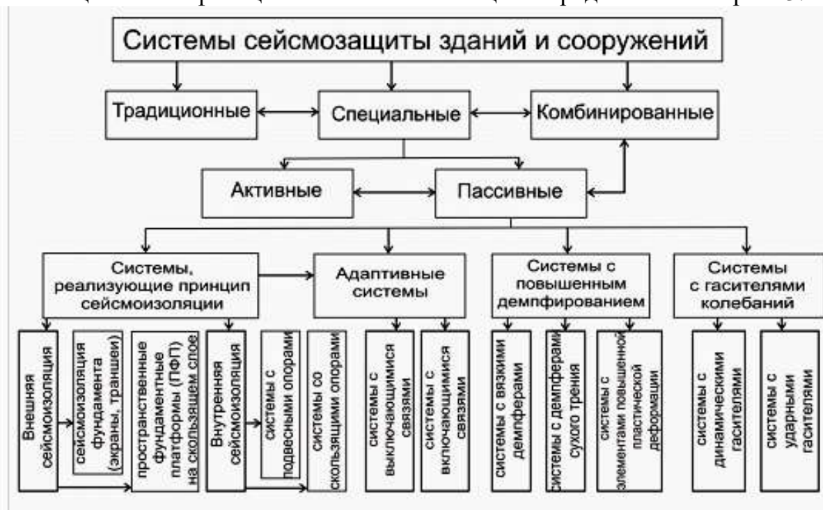
Рис. 3.12. Классификация систем сейсмозащиты по принципу их работы
