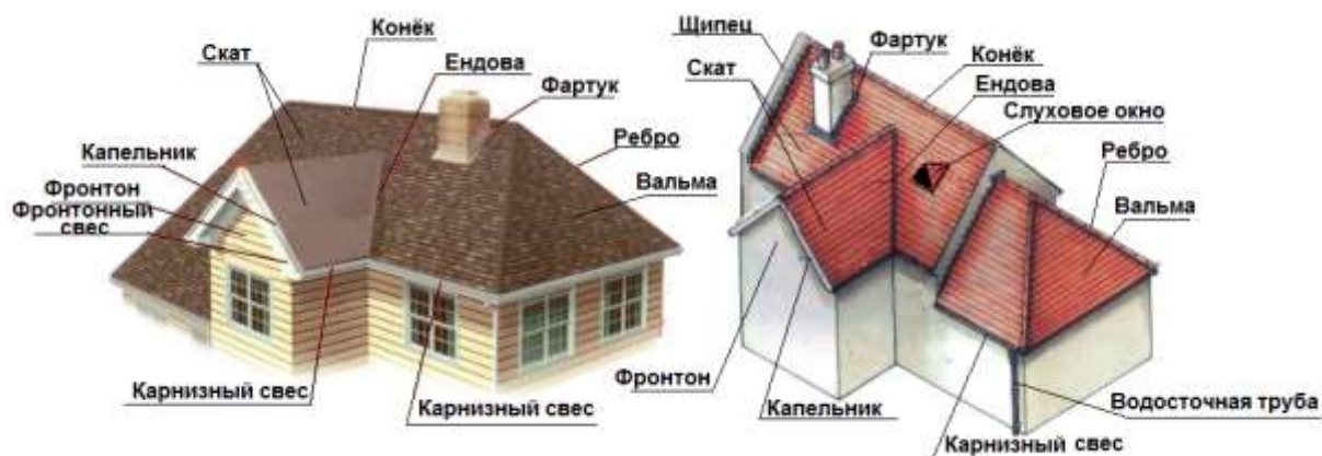
Рис. Пр1.71. Элементы кровли стропильной крыши
