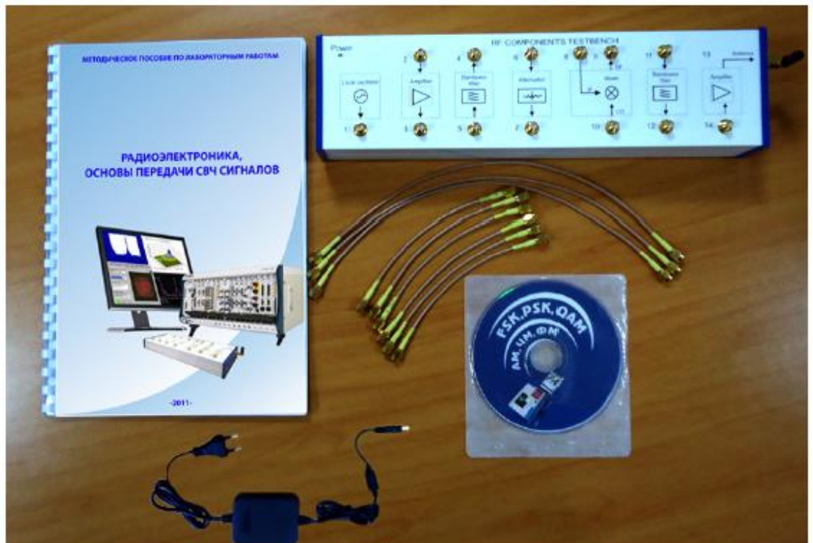
2-расм. “RF Components Test bench” стенди элементлари.
