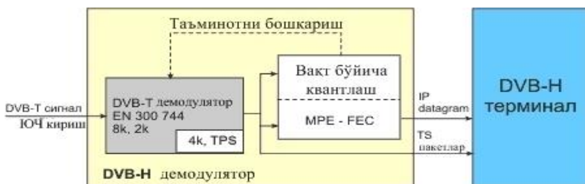
4.11.расм. DVB-H қабул қилгичнинг концептуал тузилиши
