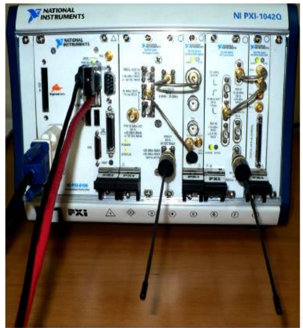
1-расм. Тизимнинг махсус кабель (а) ва антенна (б) ёрдамида уланиш схемаси.
