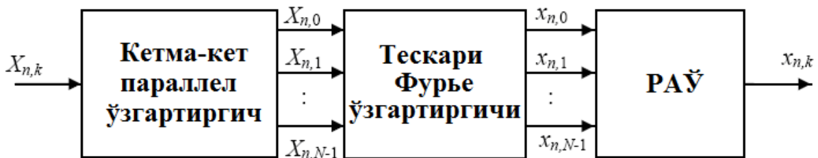
2.16-расм. OFDM сигналини ҳосил қилиш принципи.
