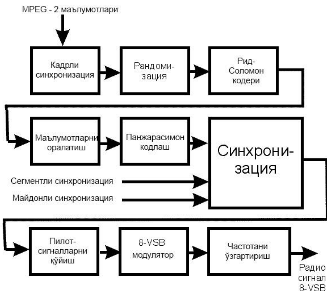
5.15-расм. ATSC тизимининг узатувчи қисми тузилиши.
