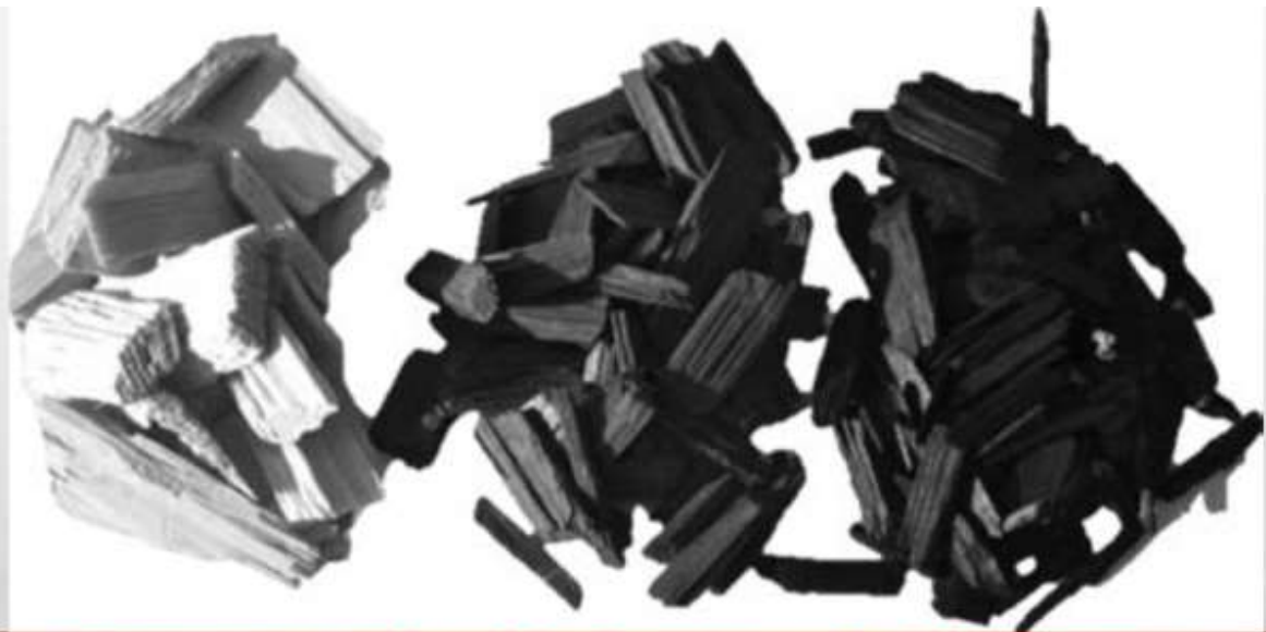
Табиий (куйдирилмаган) ёғоч бўлаклари (чапда), уларнинг куйдирилган ҳолати: оч-жигарранг (марказда) ва тўқ жигарранг (ўнгда), мос равишда 260 °С да 8 минут ва 285 °С да 16,5 минут мобайнида куйдирилган.
