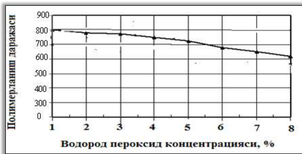
4.8-расм. Целлюлозанинг полимерланиш даражасига водород пероксид концентрациясининг таъсири.
