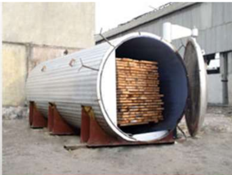
Термоёғоч олиш учун махсус герметик камера
