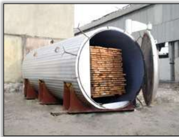
3.1-расм. Термоёғоч олиш учун махсус герметик камера
