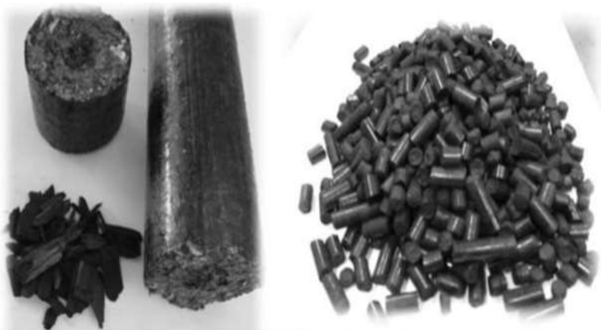
Куйдирилган ёғоч, унинг зичланган брикетлари (чапда) ва pelletлари (ўнгда)
