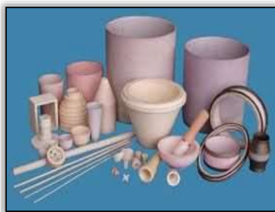
3.1.6-расм. Алюмосиликатдан тайёрланган оловбардош буюмлар (тигель, лодочка, трубкалар).
