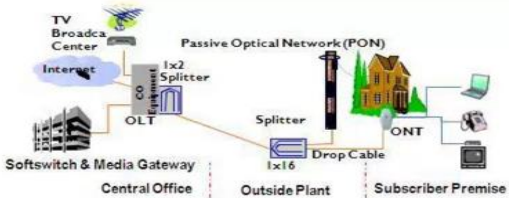
2.2-расм. Пассив Оптик тармоқнинг соддалаштирилган архитектураси.
