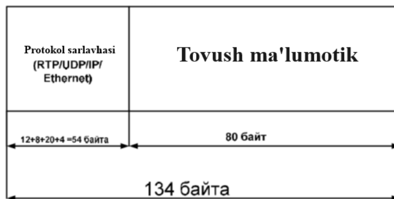
5.7 расм. IP тармоғи орқали узатилаётган G.711 кадр формати
