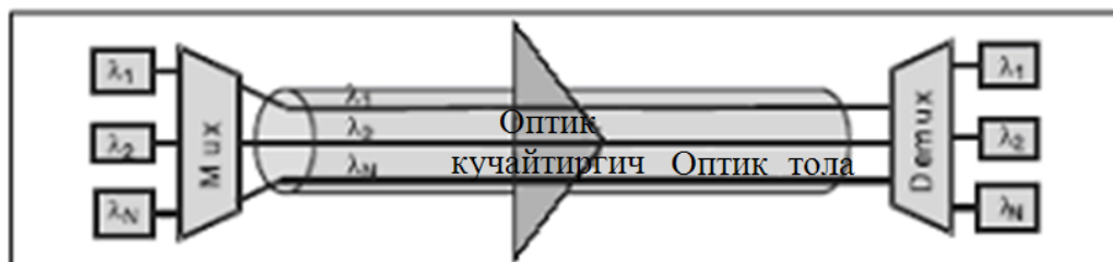
3-расм. WDM тизимларида оптик кучайтиргич толадан узатиладиган турли тўлқин узунликли сигналларни бир вақтда кучайтиради.
