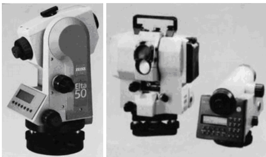
1.2–расм. Нивелирлаш ишларини автоматлаштириш: а) Zeiss фирмаси томонидан ишлаб чиқарилган Elta 50; б) Dini (10, 20, 10T, 41T).
