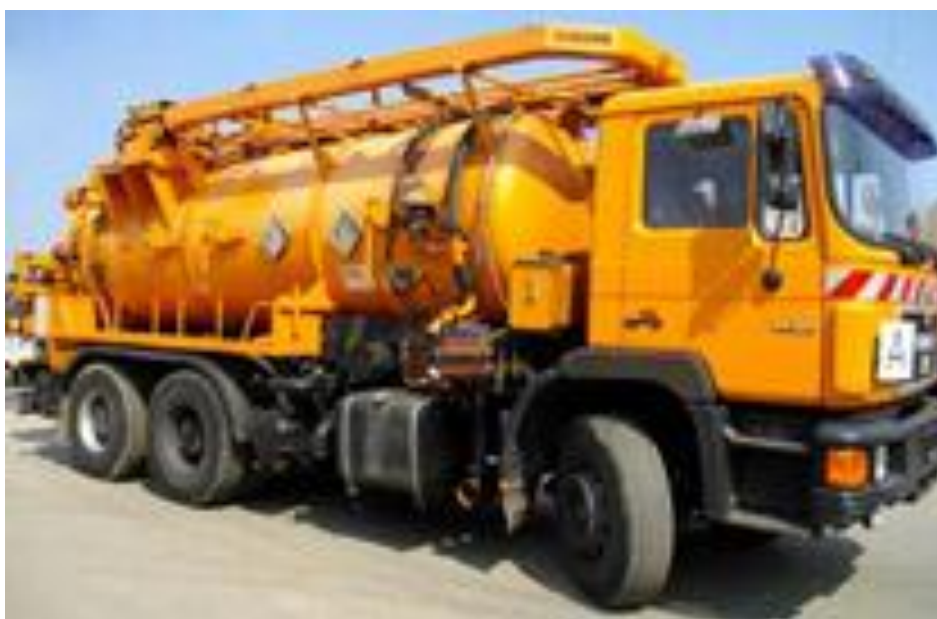
4.6-расм. МАН26.322 шассисида бажарилган канал ювиш автомашинаси. Цистерна ҳажми - 12,5 \text{ м}^3 ; ювиш қувурининг диаметри - 150-1200 \text{ мм} ; насоснинг максимал босими 14 \text{ МПа} ; насоснинг унумдорлиги - 390 \text{ л/дақ} .
