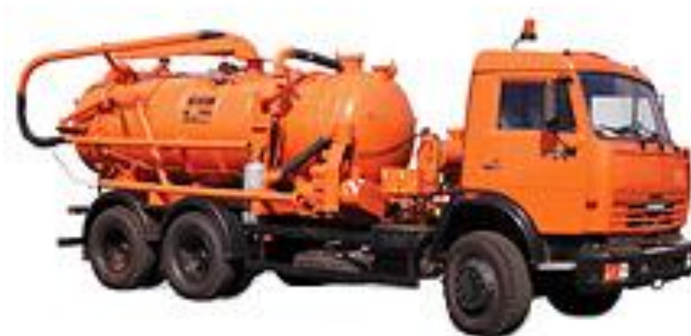
4.5-расм. КамАЗ-53215 шассисида бажарилган КО-507 АМ русумли вакуум сўриш автомашинаси. Цистерна ҳажми - 7,0 \text{ м}^3 ; гил бўлими ҳажми - 6,0 \text{ м}^3 ; гил суви бўлими ҳажми - 0,5 \text{ м}^3 ; олинадиган ашёнинг массаси - 8550 кг; ҳосил қилинадиган вакуум - 0,95 \text{ Атм} ; насоснинг унумдорлиги - 720 \text{ м}^3/\text{соат} ; сўриш баландлиги - 6,0 \text{ м} ;
