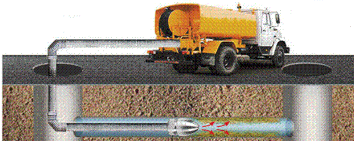
4.3 -расм.Тармоқларни гидродинамик тозалаш услуги
