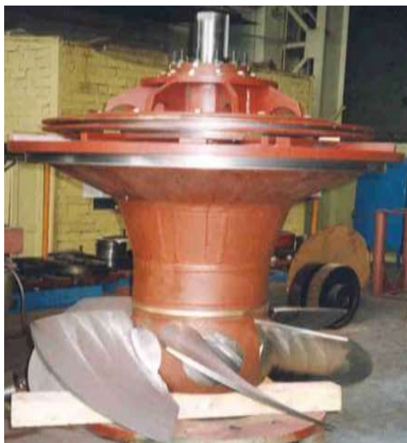
4.3 - расм. Парракли турбина роторининг йиғилган ҳолатдаги кўриниши.
