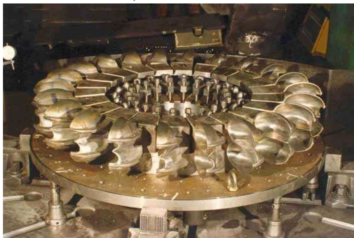
4.11-расм. Осилган(а) ва ётқизилган (б)чўмичли иш ғилдираклари.
