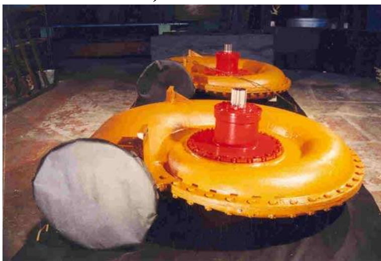
4.7-расм. Вертикал(а) ва горизонтал (б) ўрнатиладиган радиал-ўқий турбиналар.
