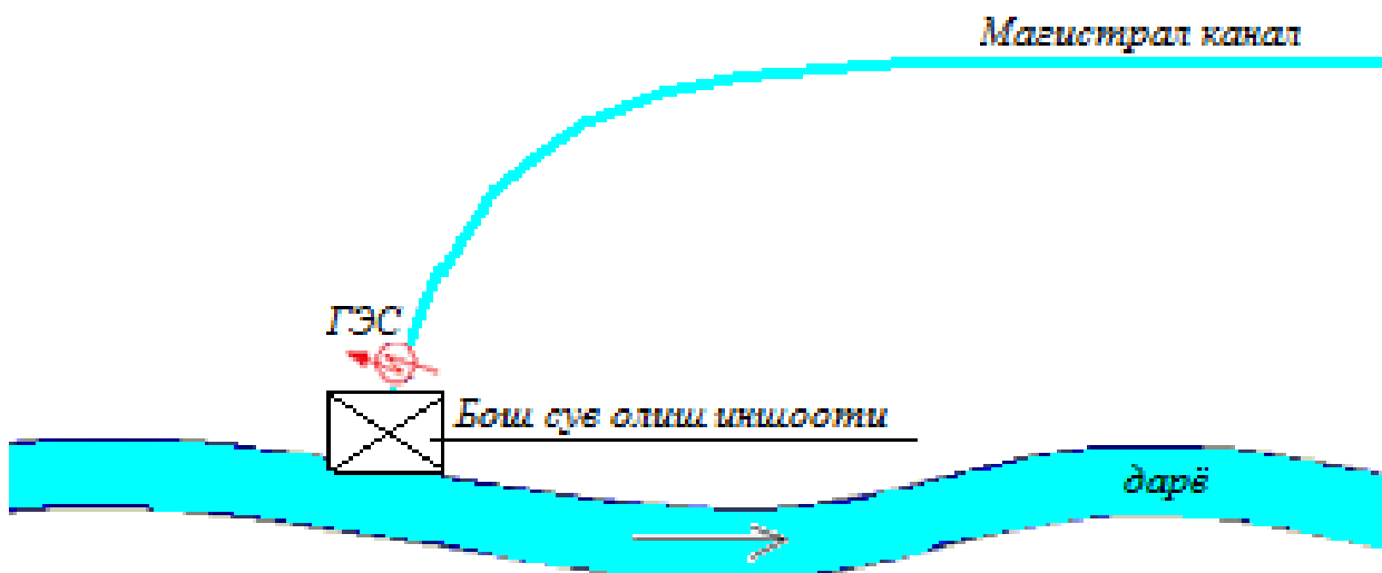
8.7-расм. Сув олиш бош иншоотига ўрнатиладиган ГЭС схемаси.
