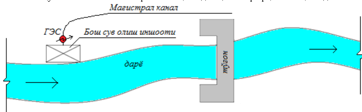
9.5-расм. Бош сув олиш иншоотидаги ГЭСнинг схемаси.
