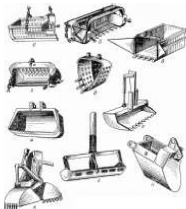
3.8-расм. Коллекторларни тозалаш учун қўлланиладиган экскаваторларнинг махсус чўмичлари.
