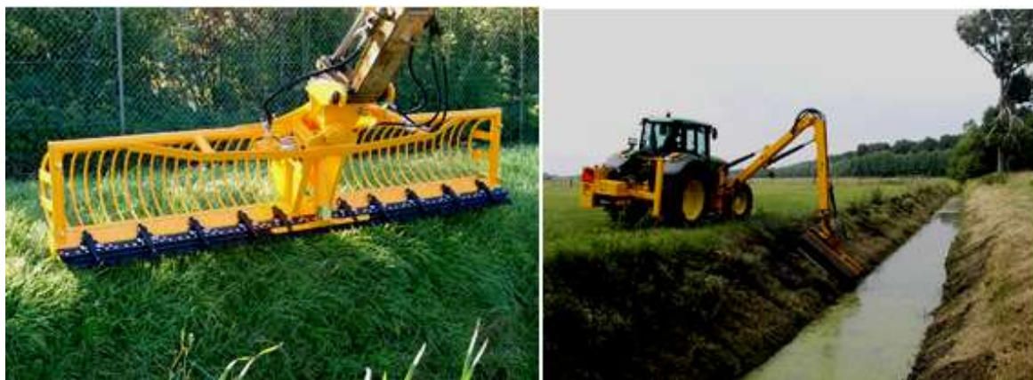
3.14-расм. Чет элда коллекторларни дағал пояли ўсимликлардан механик усулда тозалаш технологик схемалари
