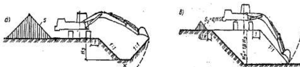
5.1-расм. Тескари чўмичли экскаваторлар билан ер ишларини бажариш схемалари а -ёпиқ ёнбош усулида қазиб схемаси; б - очик ёнбош усулида қазиб схемаси;
