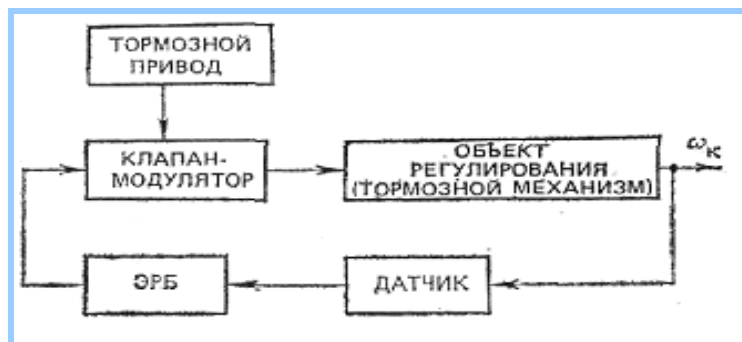
4.2 – расм. АБСнинг функционал схемаси
