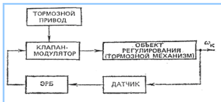
4.2 – расм. АБСнинг функционал схемаси
