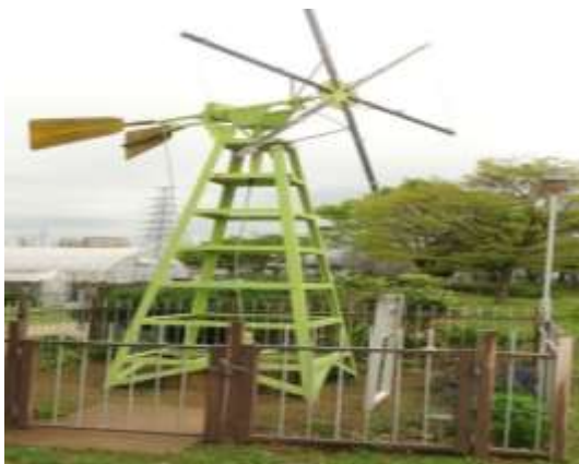
6.5 –расм. Ер ости қудугидан сув кўтариб бераётган поршенли насосни ҳаракатга келтирувчи шамол қурилмаси.
