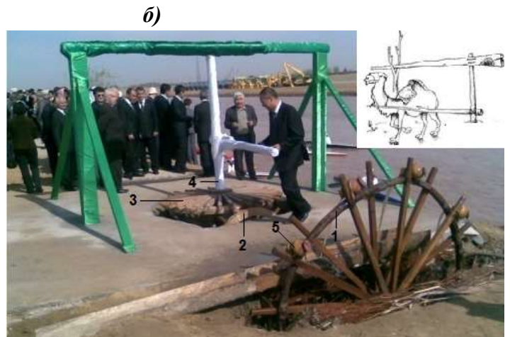
6.3-расм. Сувнинг гидравлик энергиясидан фойдаланиб сув кўтарувчи мосламалар: а-чархпалак; 1-паррак; 2-идиш; 3-нов; 4-қасқон.
