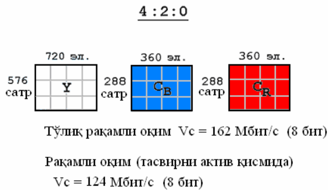
8- rasm. Tarkibiy tasvir signalini kodlash(4:2:0)
