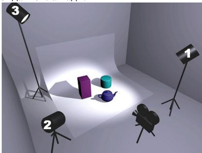
7.1-расм. Ёруғликнинг базавий жойлашуви: 1. Асосий ёруғлик (Key); 2. Тўлдирувчи ёруғлик (Fill); 3. Бўлувчи ёруғлик (Kicker).
