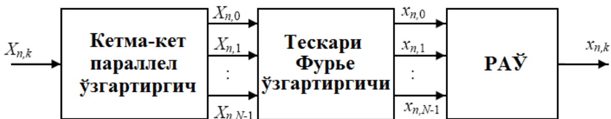
1.43-расм. OFDM сигналини ҳосил қилиш принципи.
