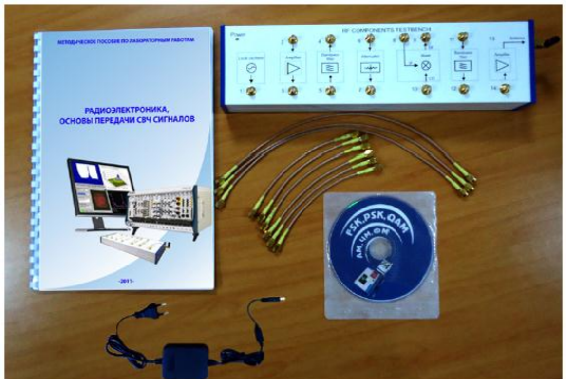
2.расм. “RF Components Test bench” стенди элементлари.
