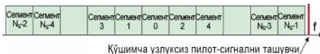
2.69 -расм. Узатилаётган радиосигнал спектри ( N_s -сегментлар миқдори)
