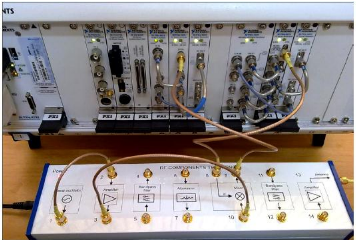
3 расм. Амалий ишнинг бажарилишидаги тизим уланиш схемаси.
