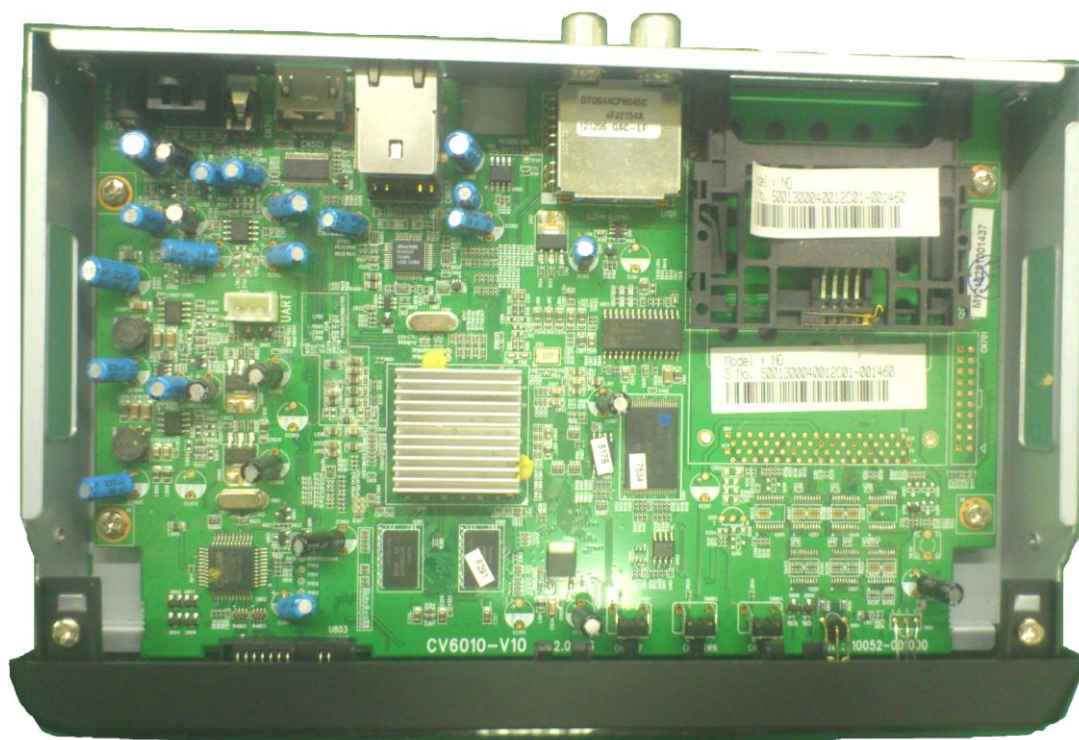
2.57-расм. TE-6010IR абонент қабул қилгичи (олди, орқа, тепа ва ички кўринишлари)
