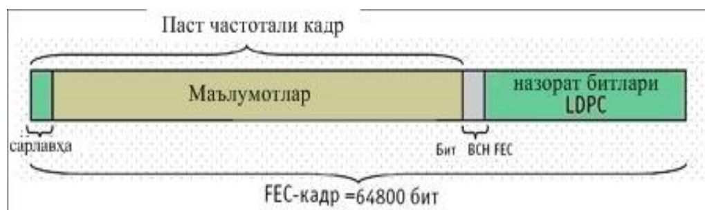
2.40-расм. Паст частотали кадрнинг структураси (BB кадр)
