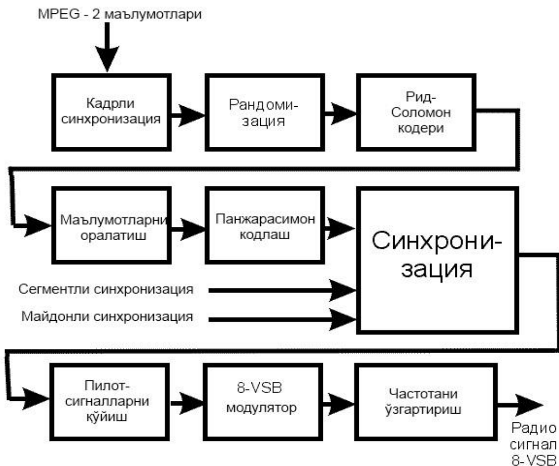
2.64 -расм. ATSC тизимининг узатувчи қисми тузилиши.
