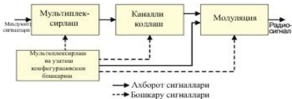
2.67 – расм. ISDB – Т тизимнинг узатиш чизмаси
