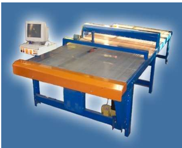
11-расм. Чарм майдонини ўлчовчи ИВА-1800 машинаси
