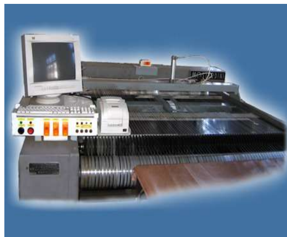
12-расм. Чарм майдонини ўлчовчи ИВА-3360 машинаси
