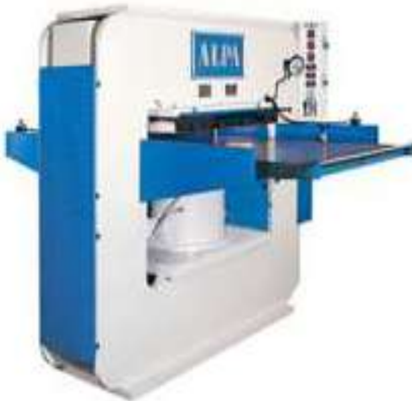
10-расм. 480 тоннали силжувчи юклаш системали дазмолувчи мерей босувчи пресс
