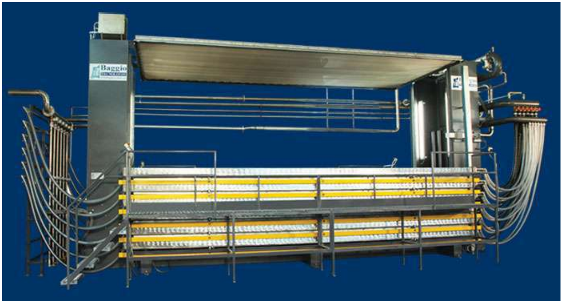
5-расм. “TIARA ERGOVAC” паст температурали вакуумли қуритиш машинаси
