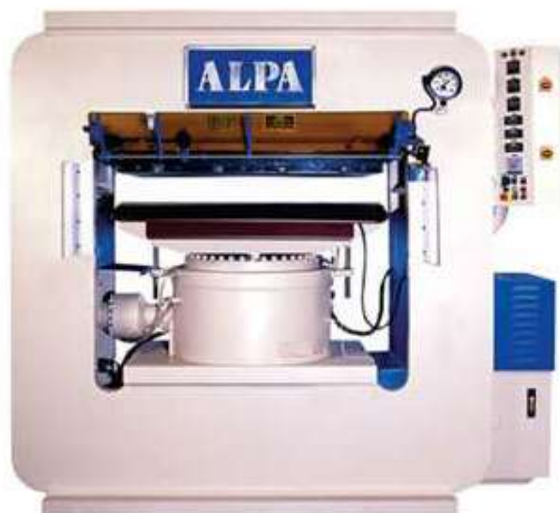
9-расм. 850 тоннали дазмоловчи меря босувчи пресс
