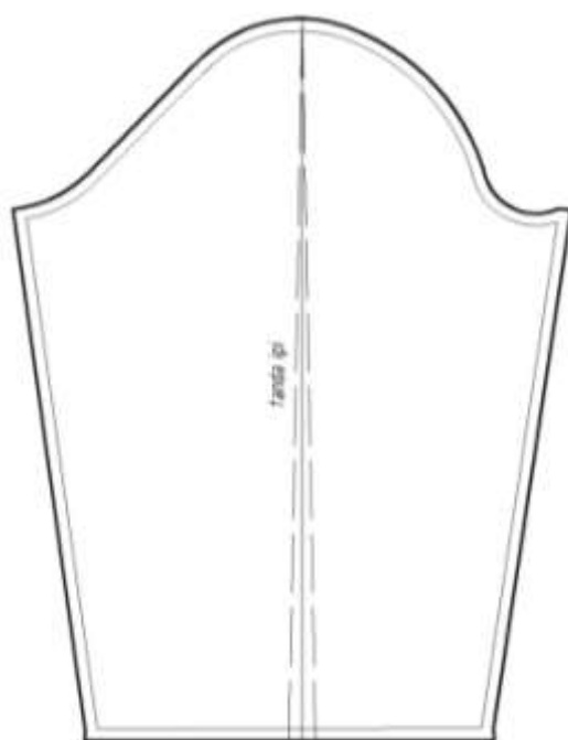
Расм. Деталларда газлама ўриш ипининг нормадан қанча оғиши мумкинлиги
