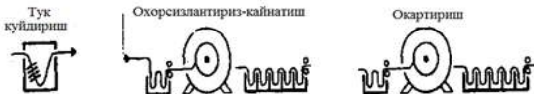
3.4-расм. Охорсизлантириш-кайнатиш жараёнлари биргаликда олиб бориладиган ярим узлуксиз пардозлашга тайёрлаш схемаси
