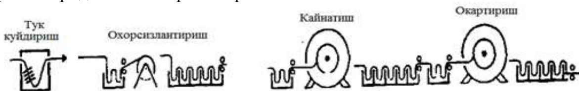
3.3-расм. Барча жараёнлар алоҳида олиб бориладиган ярим узлуксиз пардозлашга тайёрлаш схемаси
