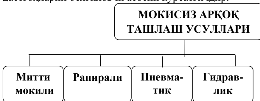
2.2-расм. Мокисиз арқоқ ташлаш усуллари
