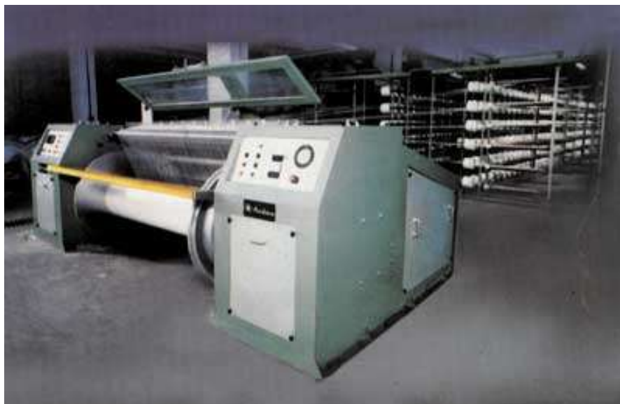
2.4.-расм Гуруҳлаб тандалаш машинаси
