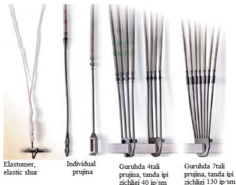
2.19-расм. Танда ипларини пастга тушириш элементлари
