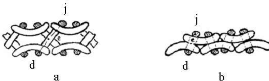
3.6 -расм. Интерлок ва ластик тўқималарининг кўндаланг кесимлари
