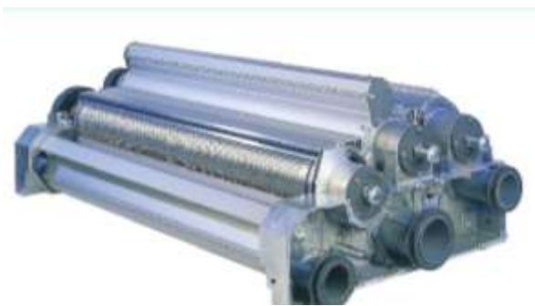
1.12-расм. Webfeed- дастлабки тараш қурилмаси
