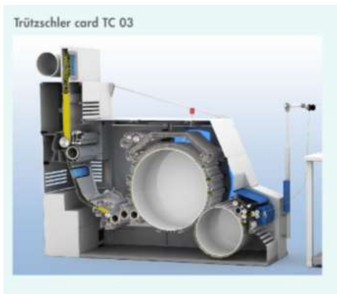
4.10-расм. Тараш дастгоҳининг кўндаланг қирқим кўриниши.
