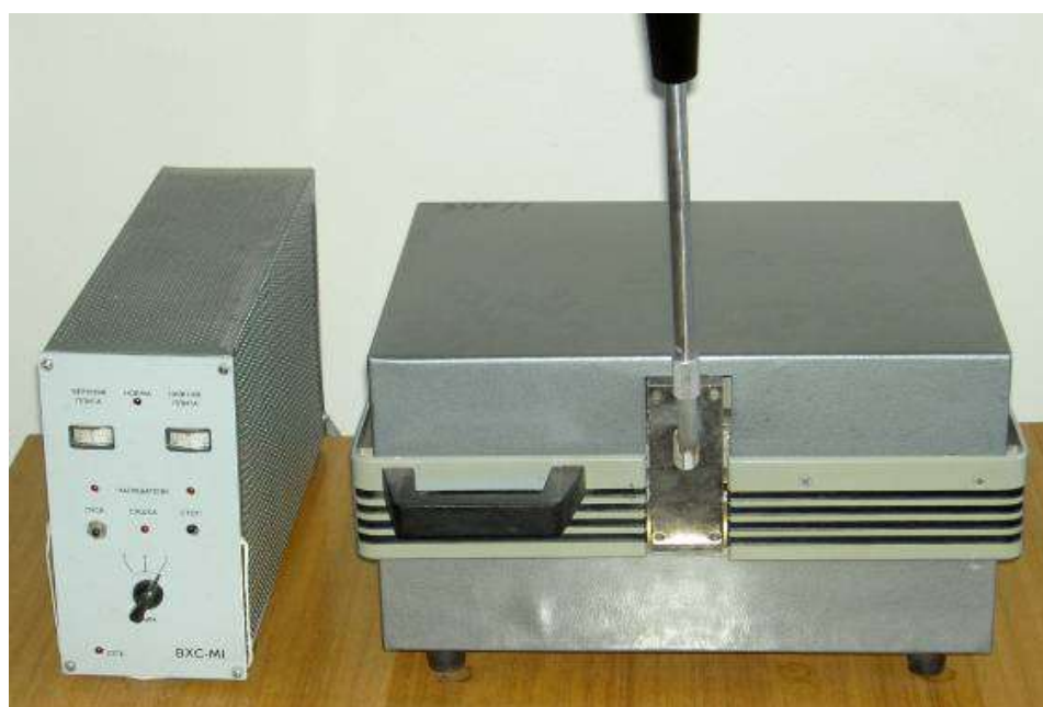
5-расм. ВХС-М1 термонамўлчагич приборининг умумий кўриниши ва схемаси
