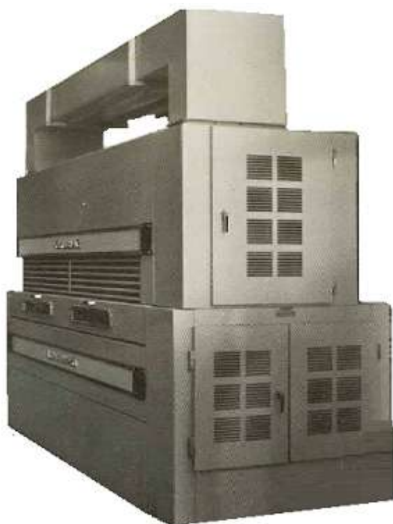
1.29-расм. Конденсор типдаги “Сикстин Д” тола тозалагичнинг ташқи кўриниши ва технологик схемаси.
