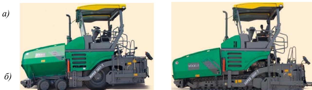
20-расм. Ҳозирги замон асфальтобетон қоришмасини йўлга ётқизувчи машиналар: а) резина ғилдиракли; б) гусеничали.
