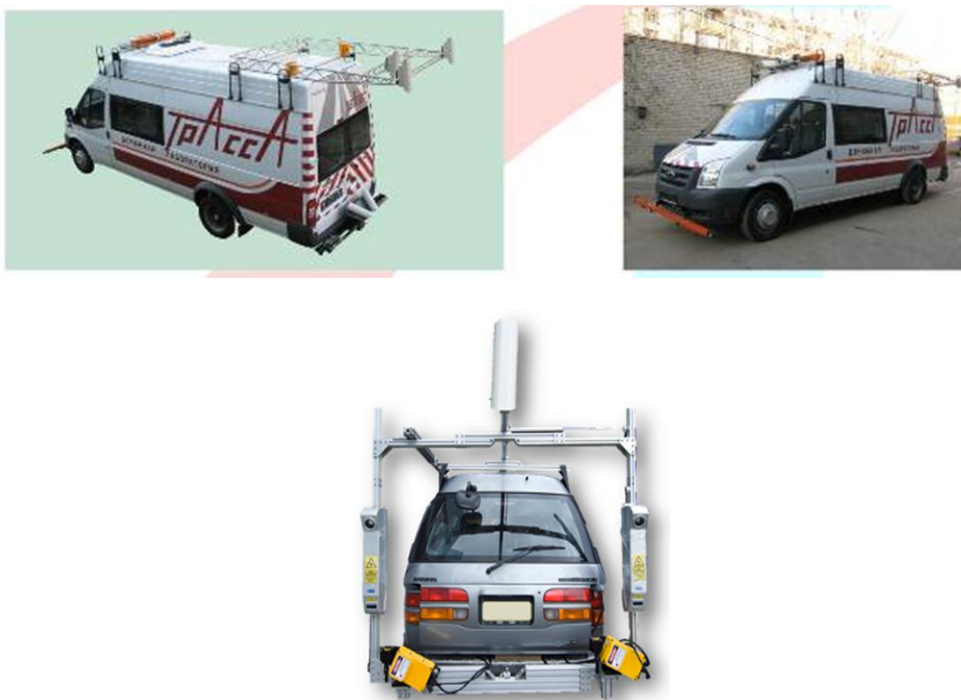
5-расм. Автомобиль йўллари диагностикасини амалга оширувчи ихтисослаштирилган кўчма лабораториялар
