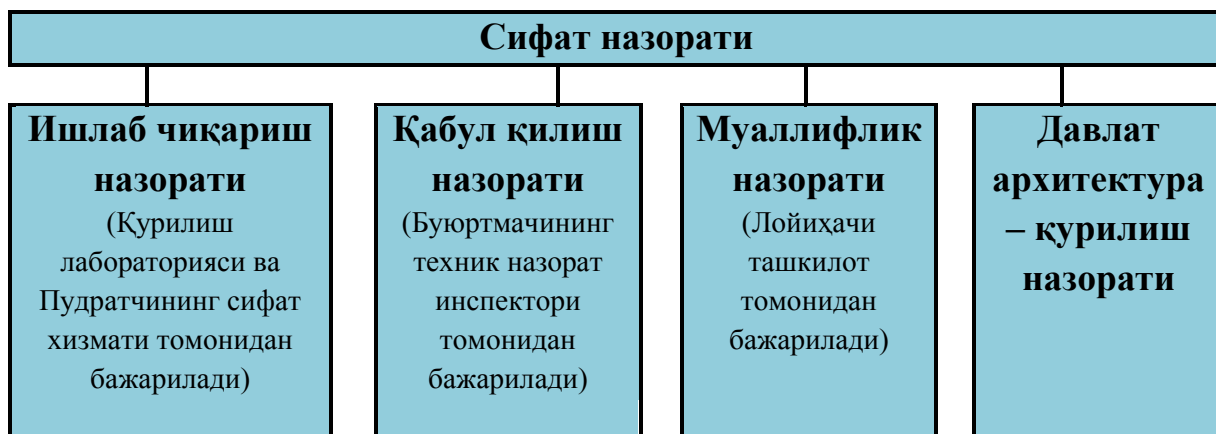
2.1-расм. Қурилиш – монтаж ишларининг сифатини назорат қилиш тизимининг ташкил этувчилари
