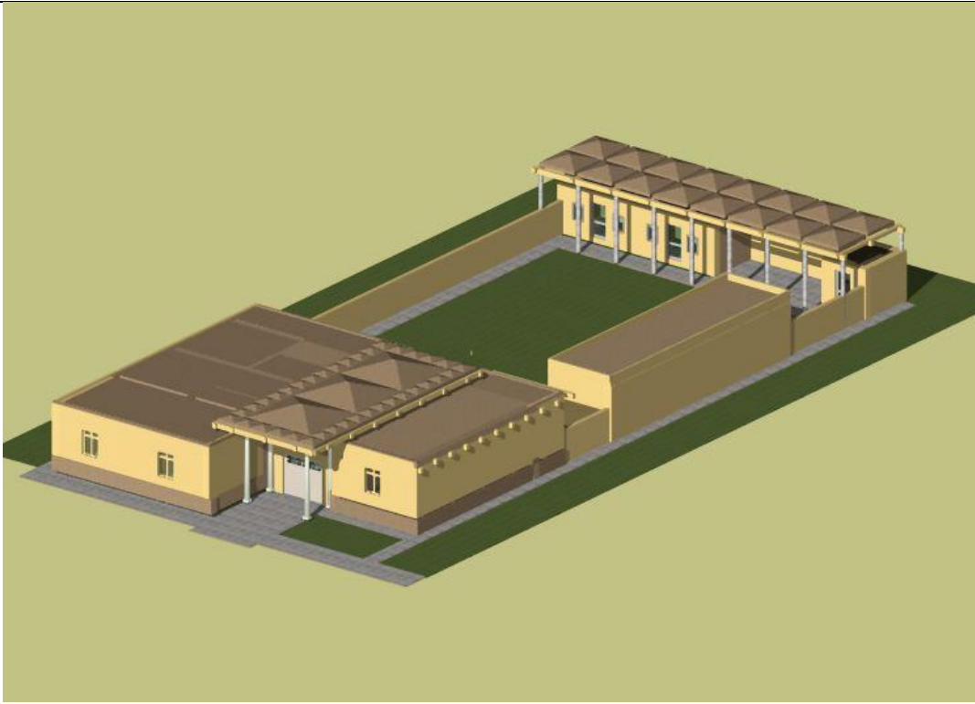
Қўрғонча туридаги 1 қаватли турар-жой биноси, қопламанинг бир қисми армоцемент қобиклардан бажарилган
