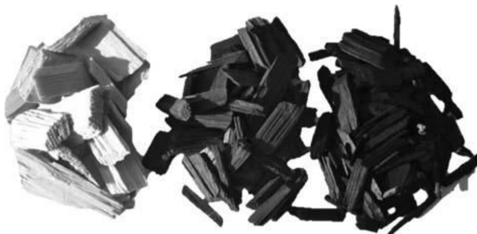
10.10-расм. Табиий(куйдирилмаган) ёғоч бўлаклари (чапда), уларнинг куйдирилган ҳолати: оч-жигарранг (марказда) ва тўқ жигарранг (ўнгда), мос равишда 260 °C да 8 минут ва 285 °C да 16,5 минут мобайнида куйдирилган.
