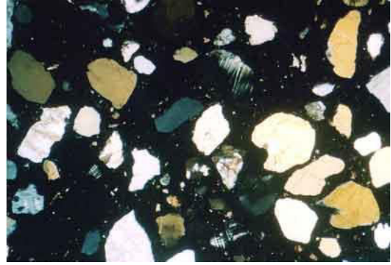
8-Расм Б. Цемент плиткасини микрорасмлари – қора рангдаги асосий масса – магнезиал цемент, йирик донали оқ рангли заррачалар – дала шпатлари, слюдалар таркибида тутган қум минераллари. катталаштириш даражаси 25^{\times} . Ўтказувчи нур, николлар кесишга холда.
