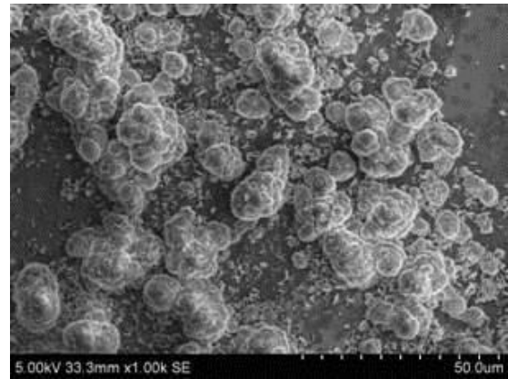
7-Расм Б. – Амин қатламини натрий метасиликати билан ишланганидан сўнг микрофотографияси T=25^{\circ}\text{C} (СЭМ, 1000X катталаштириш)
