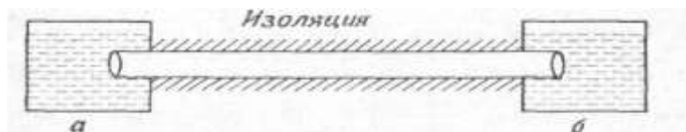
3-расм.Чегара орқали конвектив иссиқлик алмашинуви. а- g_1(t) температурали суюқлик, б- g_2(t) температурали суюқлик.
