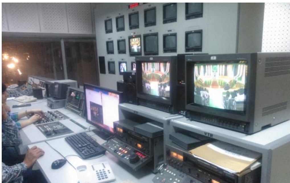
1.4- расм. Аналог ва рақамли тизимга мослашган студия пулти
