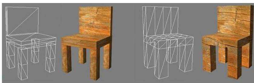
5.3-расм. “Стул” объектининг хомаки нусхасини моделлаштириш: а) Модел олтига примитивдан ташкил топган; б) Модел полигонларни тахрирлаш орқали яратилган.
