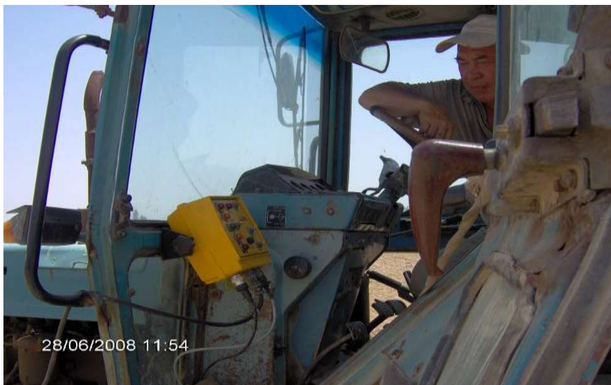
15-расм. Лазер текислагичнинг бошқариш мосламасининг трактор кабинасига ўрнатилиши.
