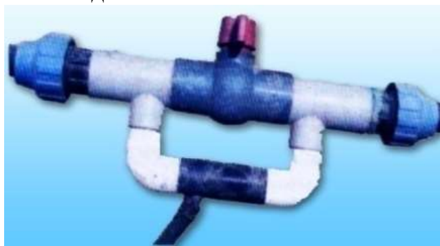
28-расм. «Вентури» типдаги инжектор ўғит эритмасини суғориш сувида бир текисда кўшилишини таъминлайди.
