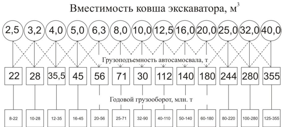
Рис. 1.20.1. Схема рекомендуемых соотношений грузопотока карьера, модели экскаватора - мехлопаты и автосамосвала для выбора экскаваторов и автосамосвалов
