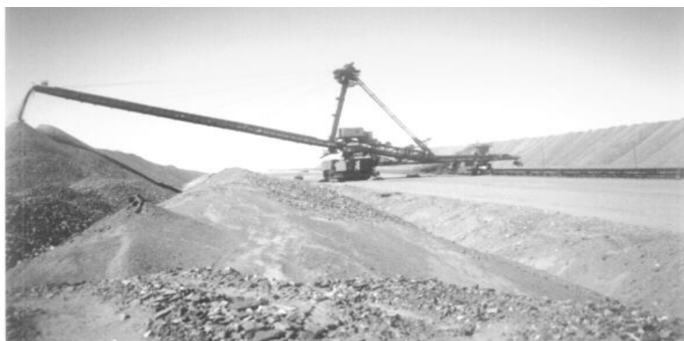
Рис. 1.24.3. Пример ограничения высоты отвала высотой разгрузки отвалообразователя
