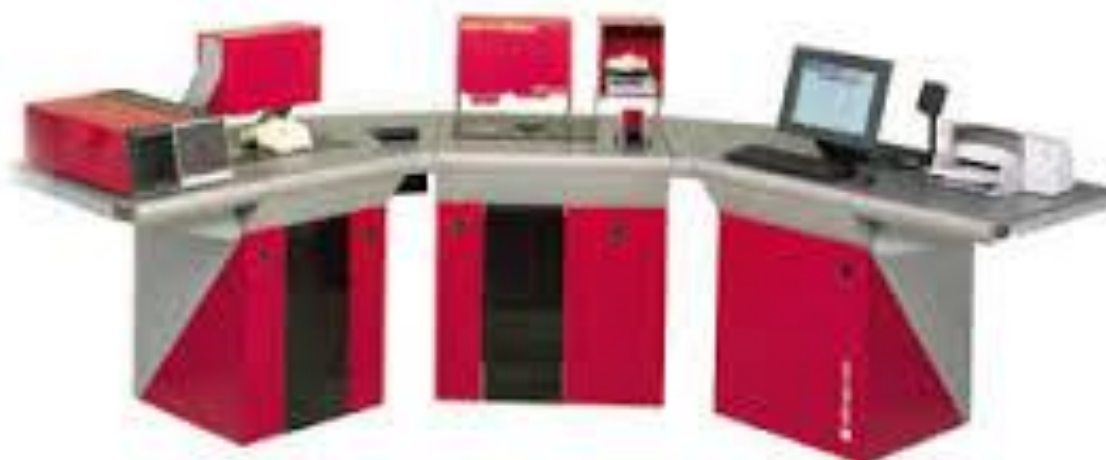
16-расм. HVI тизимининг асосий модуллари - Пахта толасининг стандарт намуналари тўплами.
