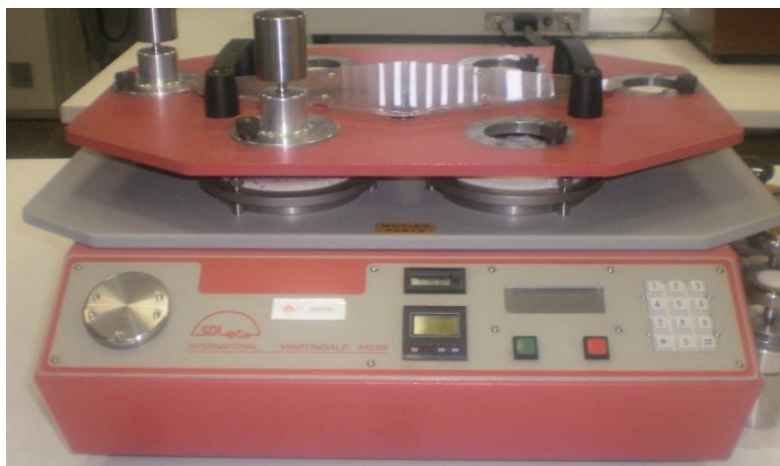
23-расм. Матоларни ишқаланишга чидамлилигини текшириш қурилмаси.
