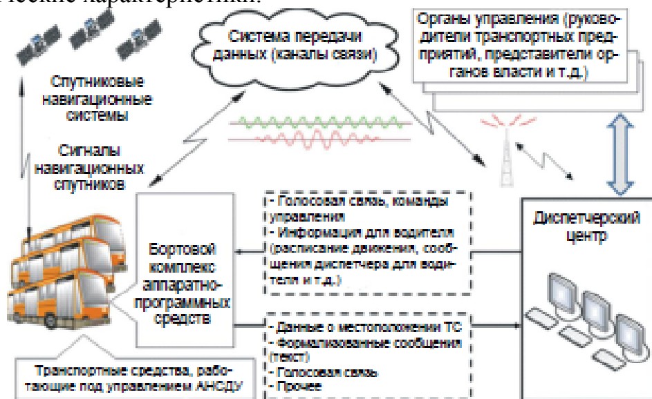
Рис. 4.1. Принципиальная схема работы АНСДУ пассажирскими перевозками на базе спутниковой навигации
