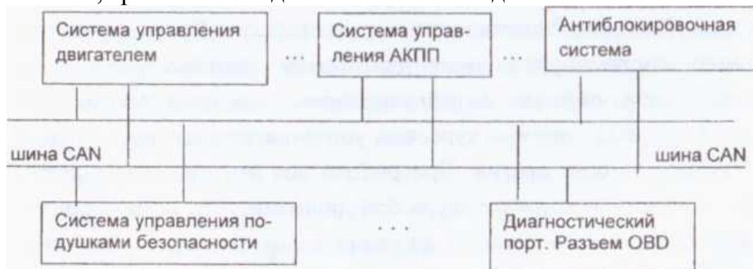
Рис. 2.1. Соединение устройств по CAN - шине
