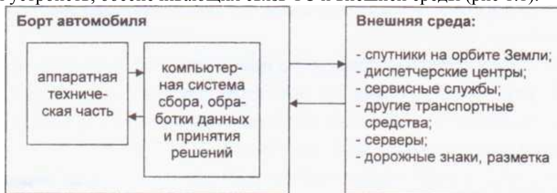
Рис. 1.1. Структура внутренней телематической системы
