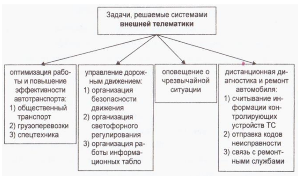
Рис. 1.4. Задачи, решаемые внешними системами телематики
