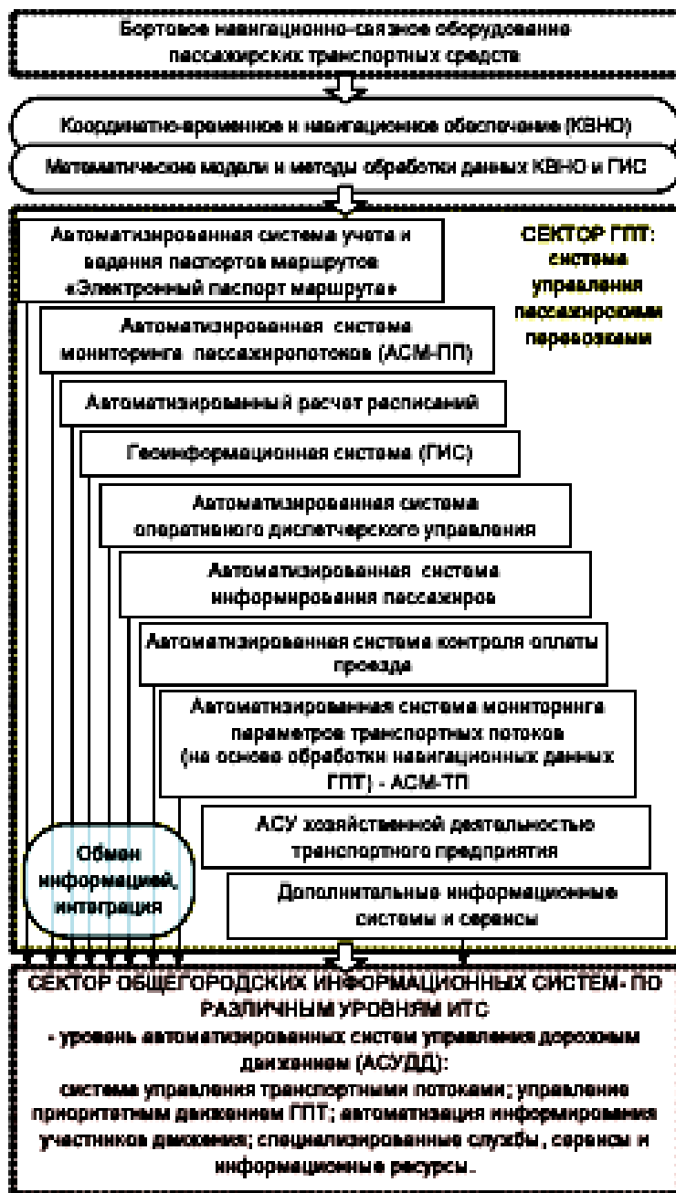
Рис. 3.2. Схема интеграции системы диспетчерского управления с другими информационными системами на городском транспорте
