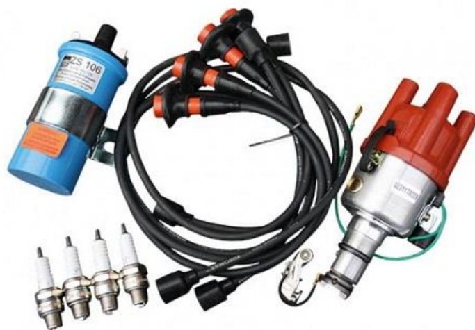
5-расм. Контактли ўт олдириш тизими элементлари
