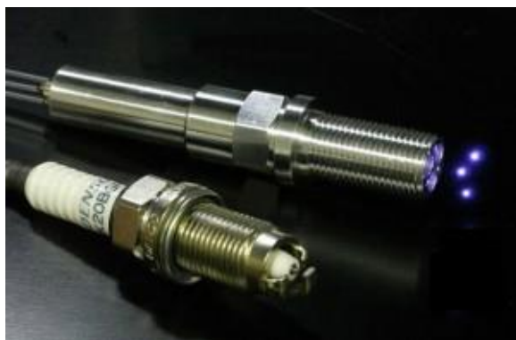
10-расм. Электродли ва лазерли ўт олдириш свечалари.
