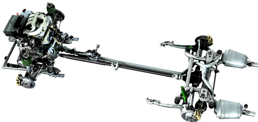
17-расм. Тўлиқ етакчи автомобилнинг трансмиссияси
