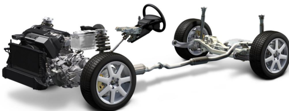
16-расм. Орқа етакчи автомобилнинг трансмиссияси кўриниши
