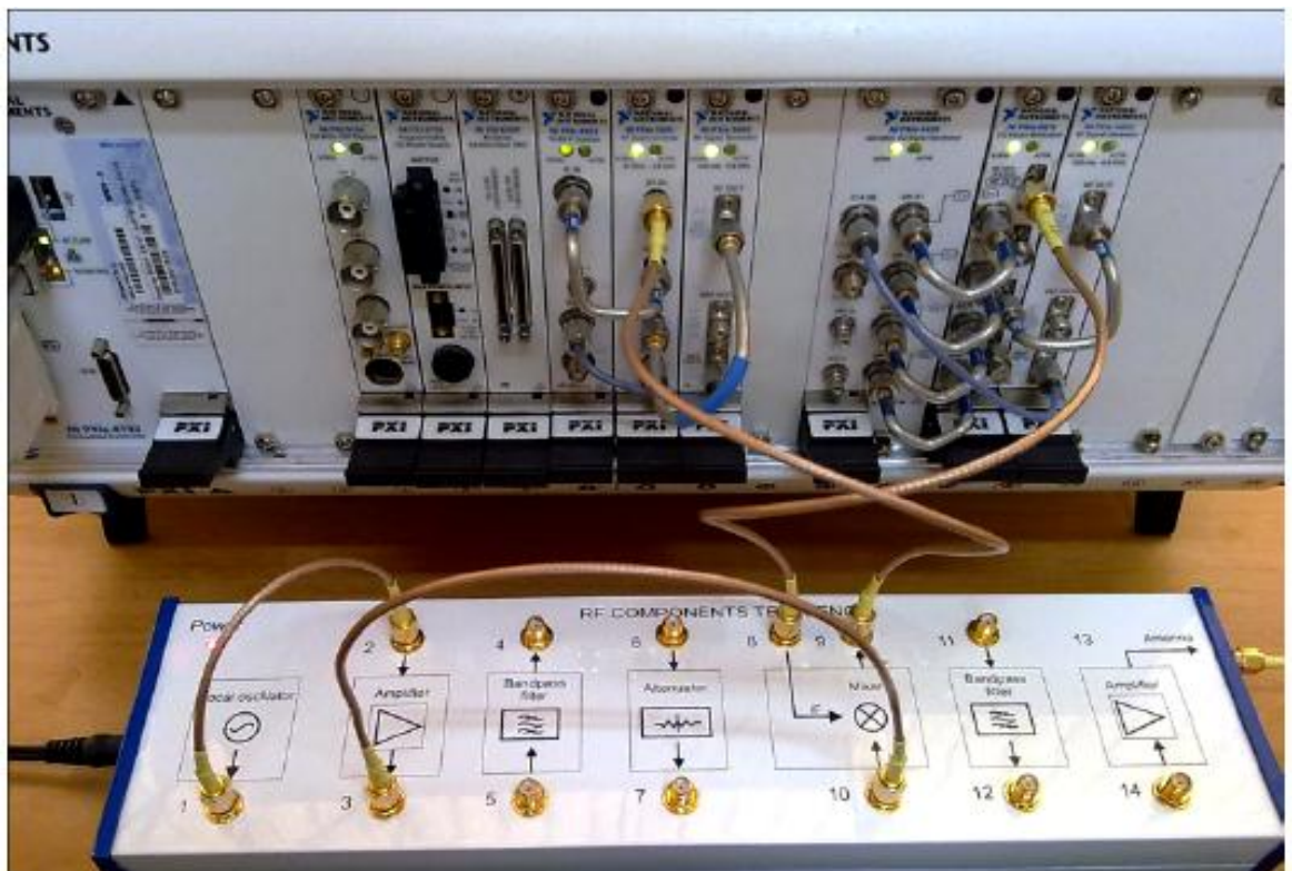
3 расм. Амалий ишнинг бажарилишидаги тизим уланиш схемаси.
