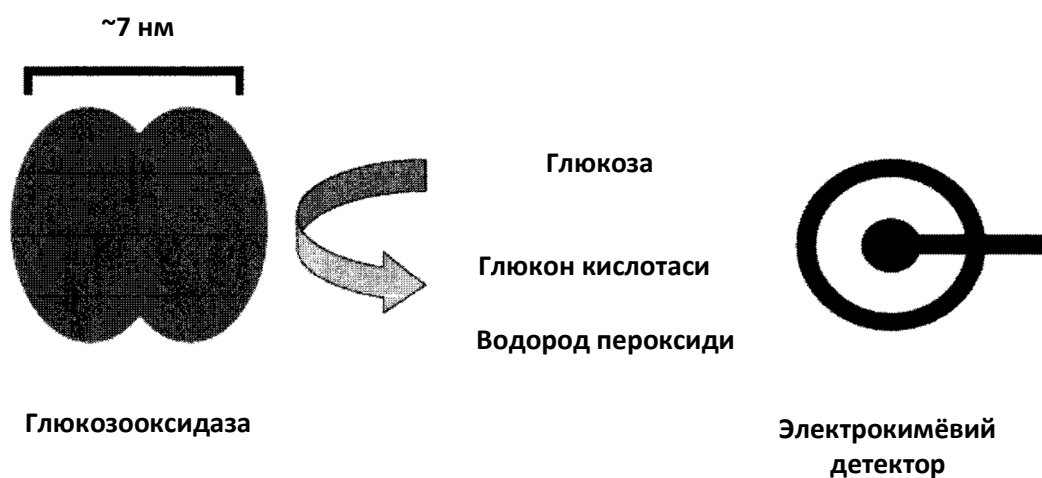
1.1-su`wret. Fermentativ reaksiya ha`m elektrokimyoviy detektor hamkorligida qon tarkibidagi glyukozani aniqlash.
