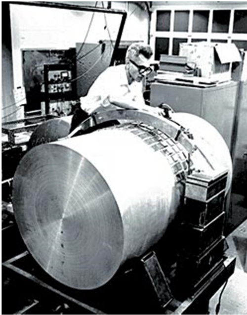
1-súwret. D.Veber óziniń detektorın jumısqa tayarlap atır. Uzunlıǵı 2 m bolǵan tutas alyuminiy kórinip tur.
