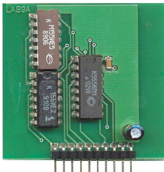
4.15 – расм. Сеччиклар ишини тадқиқ этишда қўлланиладиган Lab9A модулининг ташқи кўриниши.
