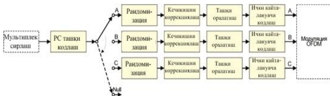
5.27 – расм. ISDB тизимида маълумотларни каналли кодлаш.
