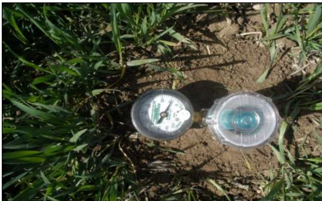
3-расм. Тензиометрлар ёрдамида тупрокнинг намлигини аниқлаб қишлоқ хўжалик экинларининг суғориш муддатларини аниқлаш
