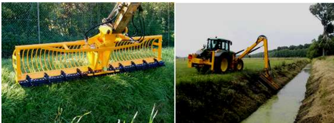
160-расм. Чет элда коллекторларни дағал пояли ўсимликлардан механик усулда тозалаш технологик схемалари
