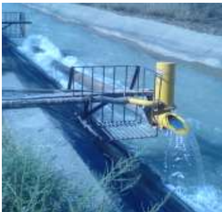
68-расм. Канал нишаблиги ҳисобига ўрнатилган гидротаран.
