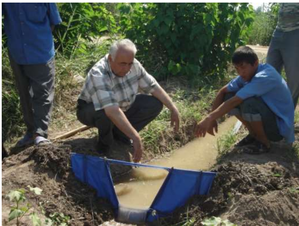
49-расм. Кўчма сув ўлчагични Хоразм вилоятида жорий қилиш
