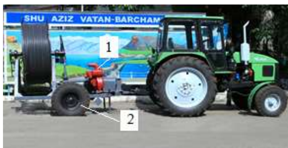
168 – расм. ПДТ-200 дренаж ювиш машинаси.
