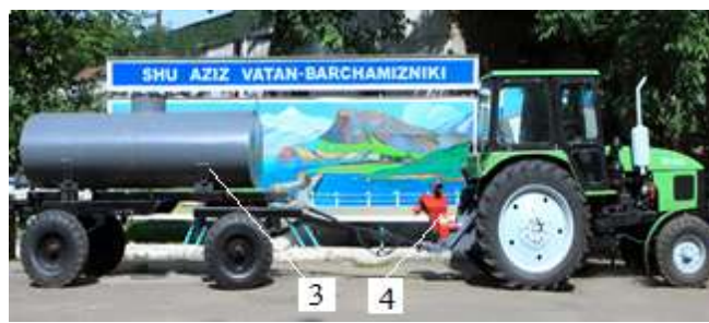
168 – расм. ПДТ-200 дренаж ювиш машинаси.
