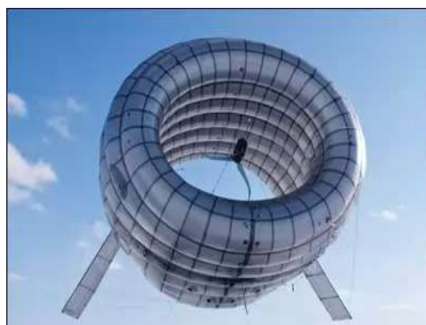
63-расм. Ҳаво шарига ўрнатилган шамол энергоқурилмалари
