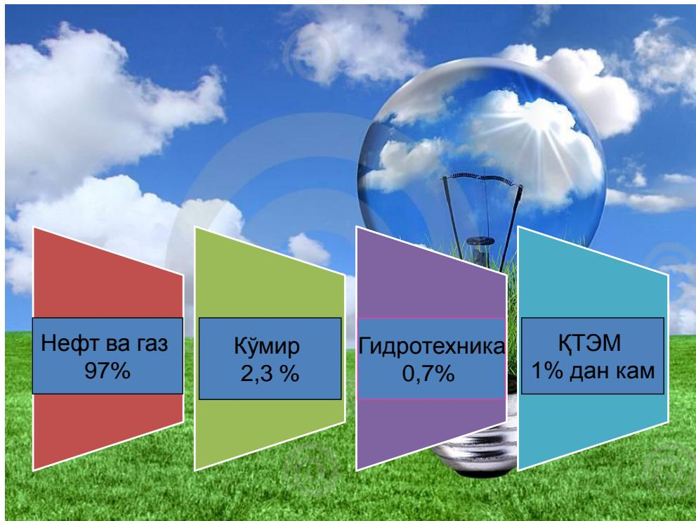
Ўзбекистонда ўрнатилган электростанцияларнинг қуввати 12,4 млн. кВт шундан, 12 млн. кВтни «Ўзбекэнерго» компаниясининг 39 та иссиқлик ва гидроэлектростанциялари беради. Электростанцияларнинг қувват ҳосил қилувчи тизимида бошқа энергия манбаларининг ҳиссаси 3 фоиздан ошмайди.
