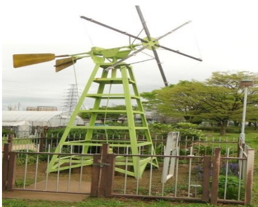
3.2-расм. Ер ости қудуғидан сув кўтариб бераётган поршенли насосниҳаракатга келтирувчи шамол қурилмаси.
