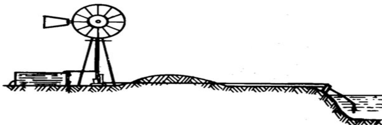
3.3-расм. Ер усти манбасидан сув кўтариб бераётган поршенли насосниҳаракатга келтирувчи шамол қурилмаси.
