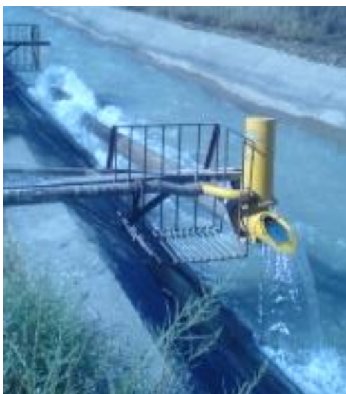
65-расм. Канал нишаблиги ҳисобига ўрнатилган гидротаран.
