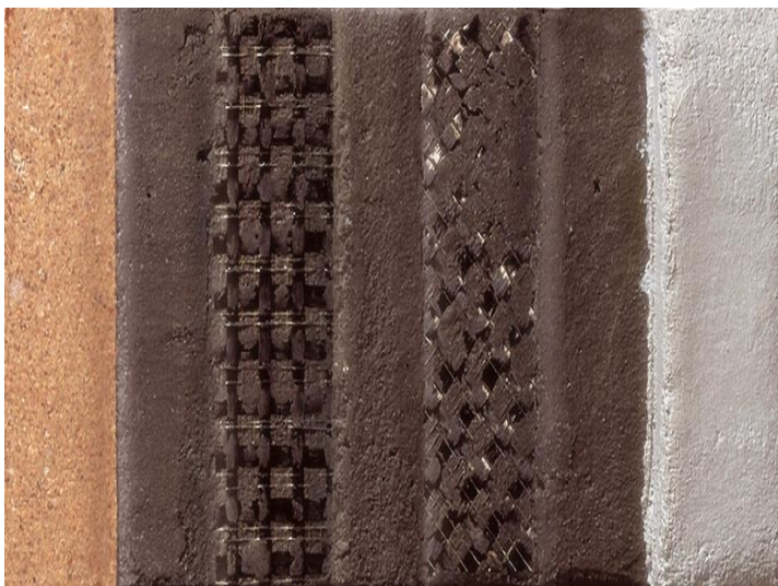
Икки сеткали углеводороддан арматураланган сувоқ қатлами таркиби
