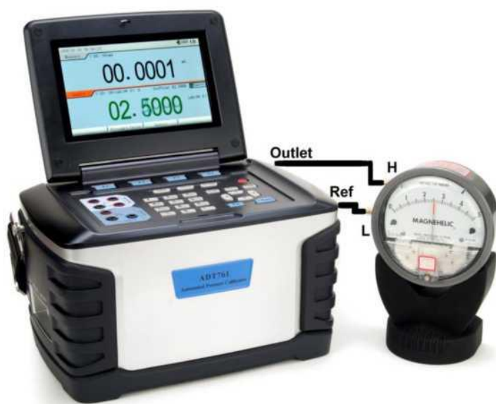
Рисунка 4. Калибратор ADT761 с DUT
