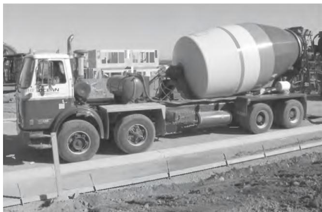
Расм 4-6. Автобетонаралаштиргич билан бетон ташиш
