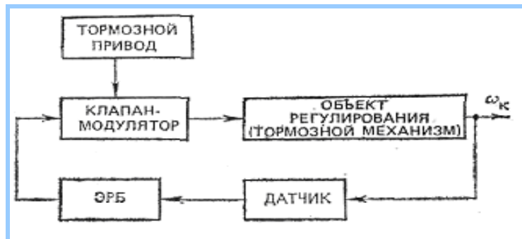
4.2 – расм. ABSнинг функционал схемаси
